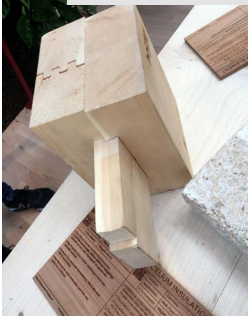
Frézované zubové spoje dřevěných prvků, které nevyžadují použití lepidel ani hřebíků nebo vrutů (tým MIMO)
