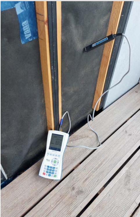
Dynamické měření tepelné vodivosti dřevovláknité izolace
