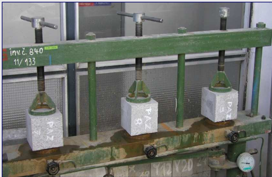
Zkouška vodonepropustnosti podle ČSN EN 12390-8
